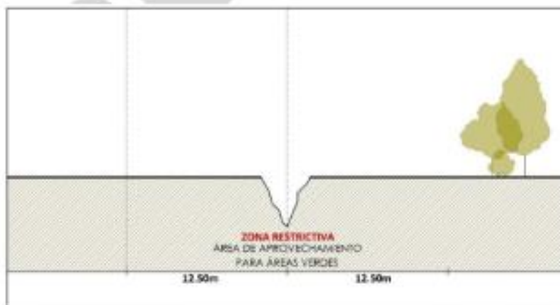
Figura 26 Área de restricción en grietas superficiales municipales.
